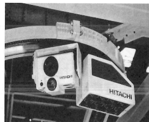
図-3 移動式点検ロボット
