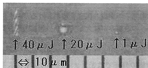
Fig. 4 光のエネルギーによる加工点形状の変化
