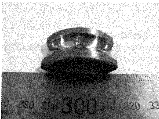
写真3 内輪傷の写真
