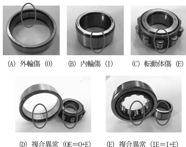
図3. 衝撃系異常状態の装置の写真
