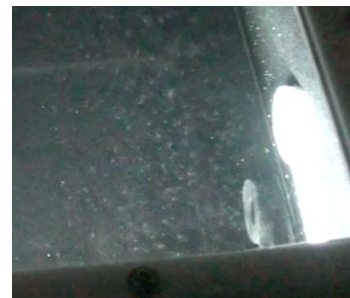
図 3 Fe-55 線源からの 5.9keV X 線による飛跡
