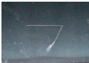
図5 Th-232 を含むランタンからのα線による飛跡
