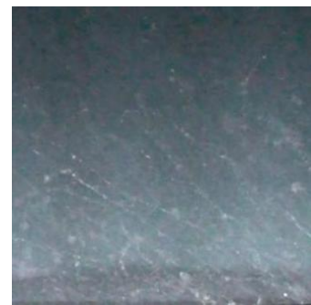
図 4 Cs-137 線源からの 662keV \gamma 線による飛跡
