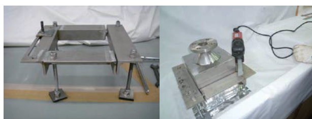
水平切断治具 レシプロソーを取付た様子 図11 水平切断治具
