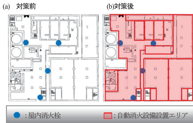
図2 消火設備配置図(対策前後)
