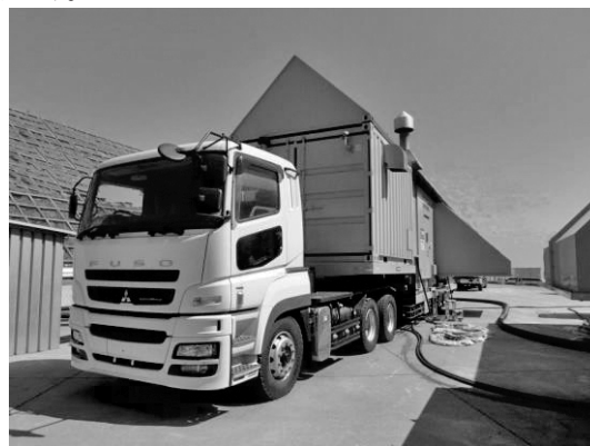
図4 常設非常用発電機
