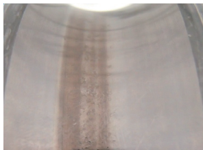
図 20 内輪転走面摩耗痕
