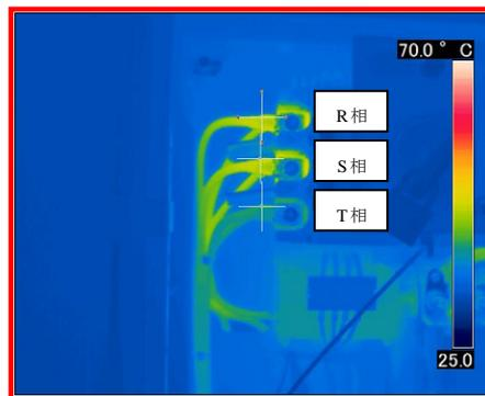
図11 1号機 HPSW ポンプ電動機用遮断器の熱画像（清掃後）
