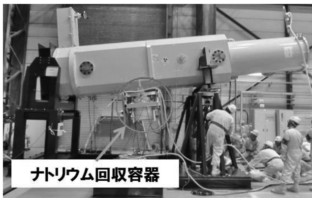
図10 ナトリウムドレン作業状況
