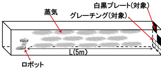
図6 蒸気環境下での視認性確認試験
