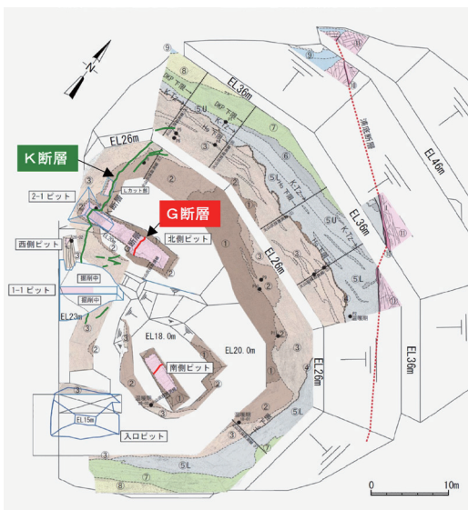
図2 D-1トレンチ（前報時形状）で確認されたG断層とK断層
