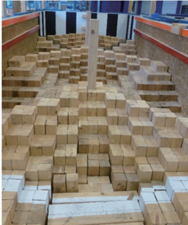
図8 災害時対応ロボットに向けた対称標準試験法 (Symmetric Standard Test Method) に準拠した試験場。縦横それぞれ10cm、長さ10, 20, 30, 40, 50 cmの角材により構成されている。
