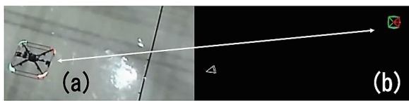
図10 (a) 飛行試験中の室内ドローン（縦と横のサイズはそれぞれ 80 cm）の写真。(b) 白線の先にデジタル化してコンピューター上に表示したドローン。
