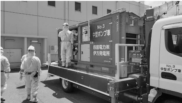
図1 中型ポンプ車による海水補給作業
