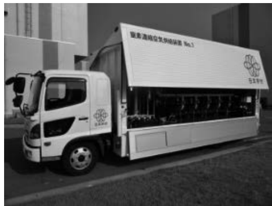
図8 窒素濃縮空気供給装置
