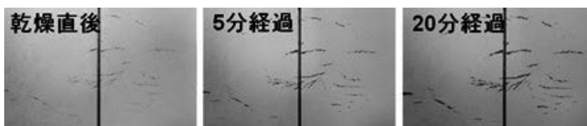
図 3 経過時間ごとのきず指示模様の例(速乾式現像法)
