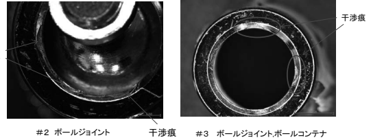
図 1.20 ボールジョイントコンテナ縁の干渉痕
