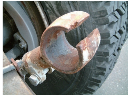
図 3.1 異常な破壊が疑われた左側ロッド端部の外観(車軸に取り付いた状態)
