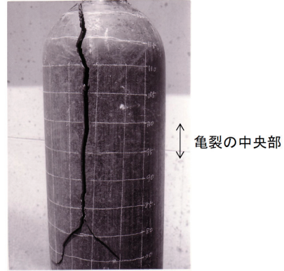
図 3.10 破裂したポンベの外観
