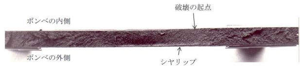
図 3.11 亀裂中央部を含む破面と破壊起点の特定
