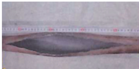
図8 クリープによるチューブリーク例
