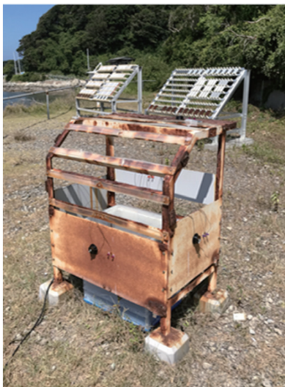
図2 横須賀地区に設置している大気暴露試験台
