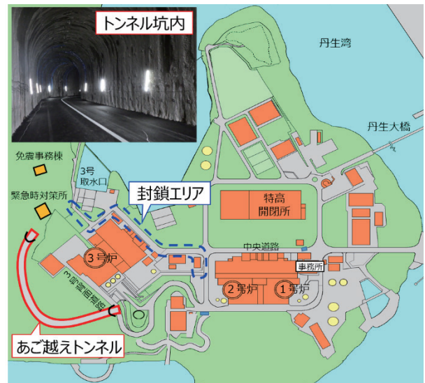
図13 あご越えトンネルの概要
