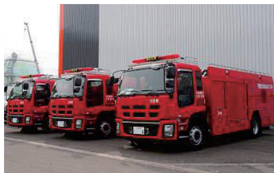
図 15 可搬型大型送水ポンプ車（図 13 の②）
