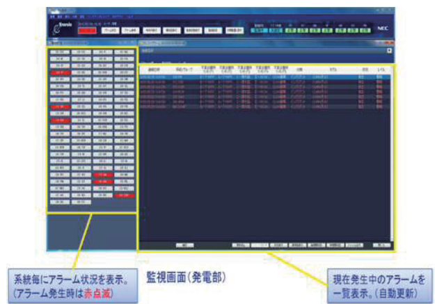
図-16 システム監視画面例
