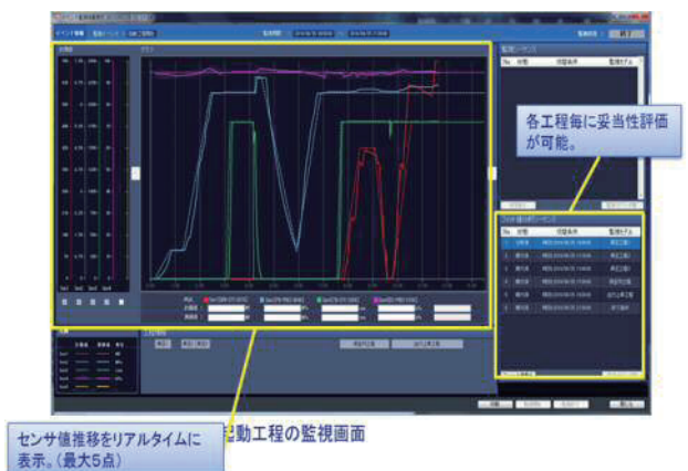
図-8 プラント起動工程監視画面
