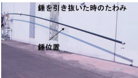
図9 錘の位置を移動させた時のたわみの変化
