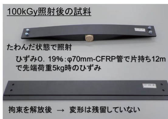
図 7 照射による残留変形の有無の確認試験
