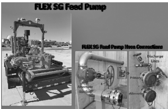
図2 FLEX 機器のうち SG 給水ポンプ
