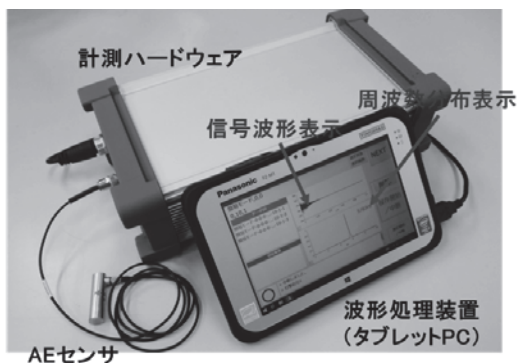
図 4 AE センサを用いた打音検査装置
