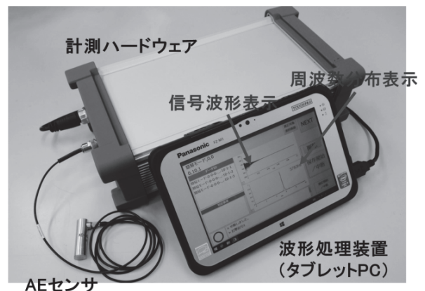
図1 AEセンサを用いた打音検査装置
