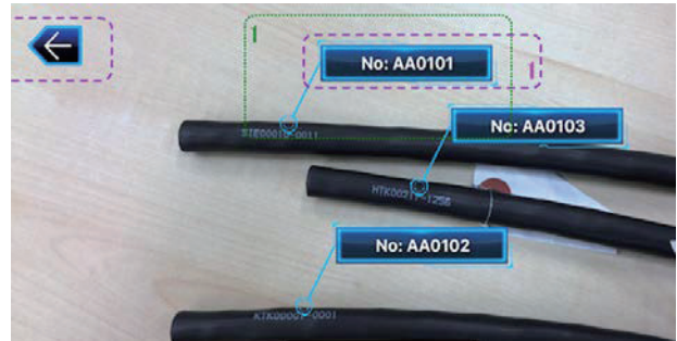
図3 携帯端末上でのケーブル番号の表示例
