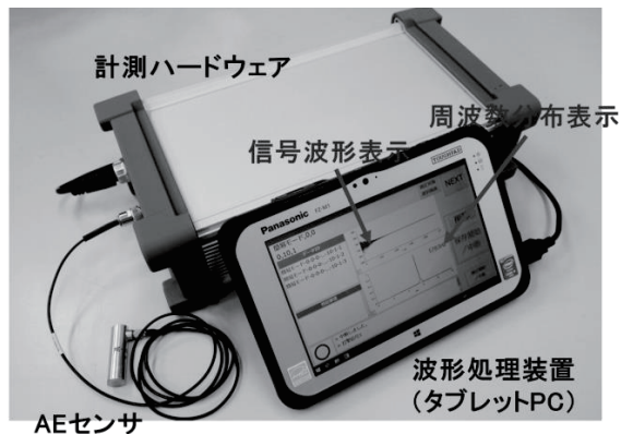
図 2 AE 打音現場検査システム
