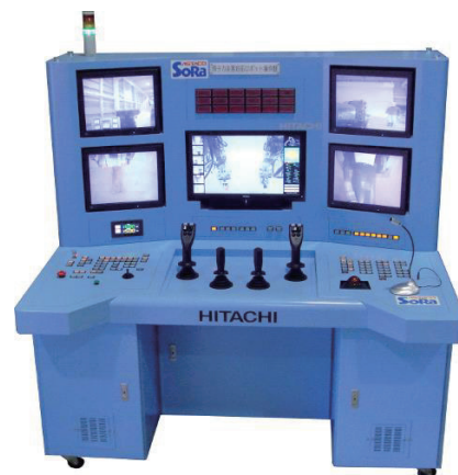
図2 「ASTACO-SoRa」の遠隔操作盤外観
