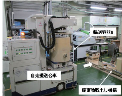
図9 廃棄物取出し機構への自走搬送
