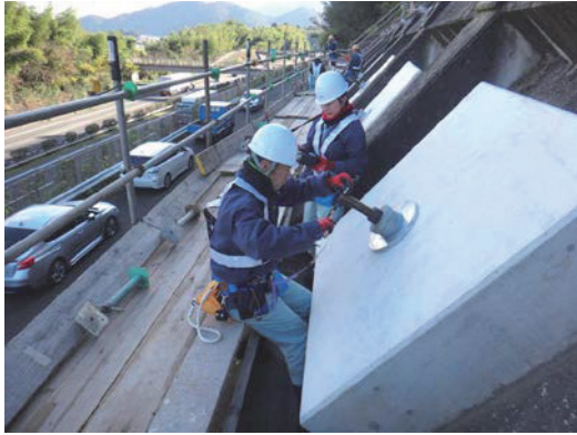
図4 AE センサを用いたデジタル打音検査状況
