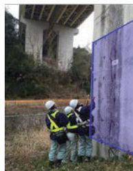
図1 デジタル打音検査とAI・シミュレーションの統合的活用によるコンクリート内部構造診断
