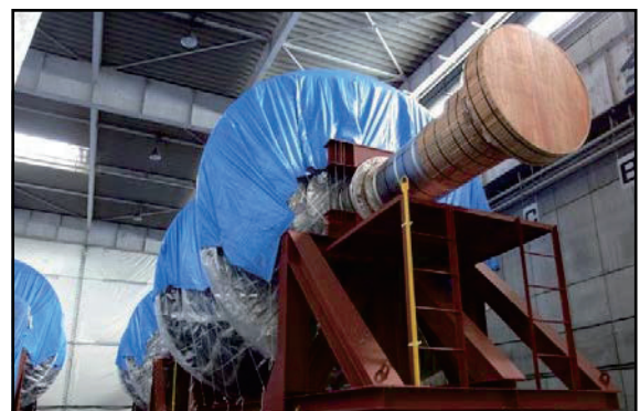
図4 工場における保管状況（主タービンローター）
