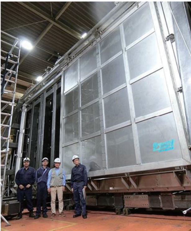
図4. ブローアウトパネル閉止装置全景[2]
