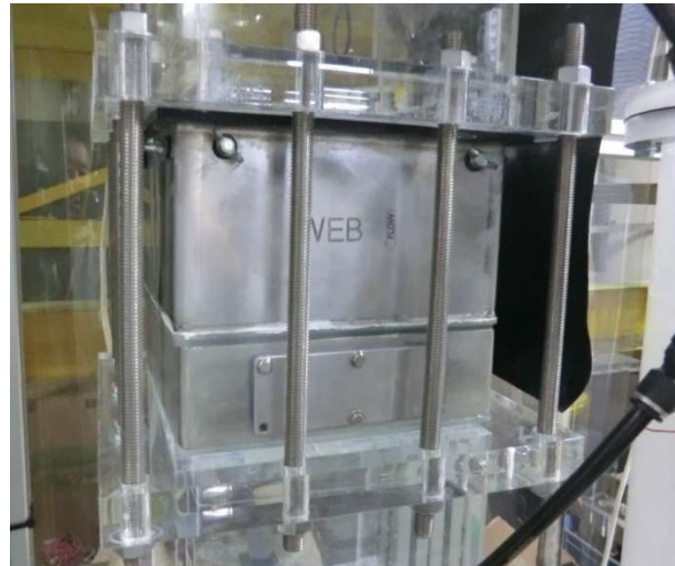
図6 多層複合フィルタを挿入したフィルタ治具外観
