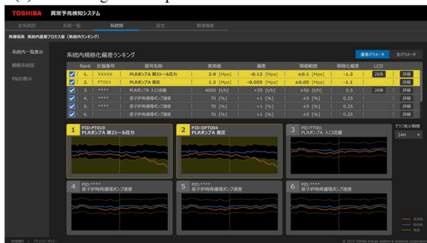
図1 異常予兆検知システムの画面例 (a) トップ画面、(b) 1系統の偏差ランキングと、プロセス値と予測値のトレンドデータ
