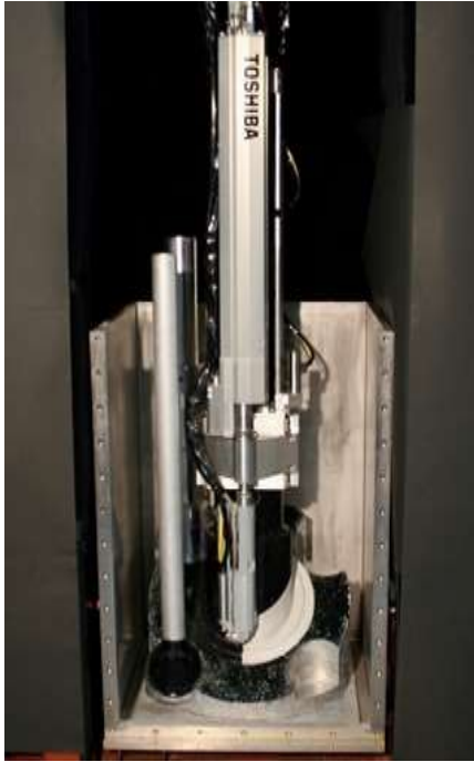
図3 BWR炉底部用ポータブルLP装置 所有機関：東芝エネルギーシステムズ㈱
