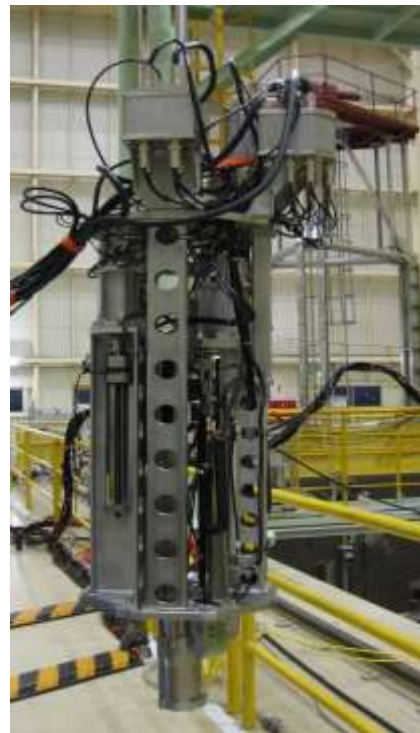
図2 PWR 炉内計装筒管台用 WJP 装置 所有機関：三菱重工業(株)
