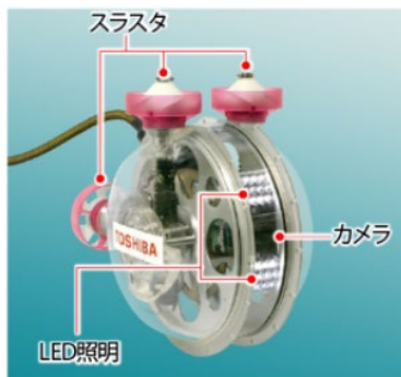
図1 東芝エネルギーシステムズ株式会社所有 水中遊泳ビークル外観
