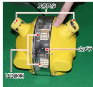
図2 日立GEニュークリア・エナジー株式会社所有 水中遊泳ビークル（M型）外観
