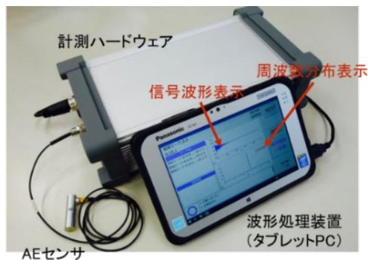
図1 デジタル打音検査計測システム
