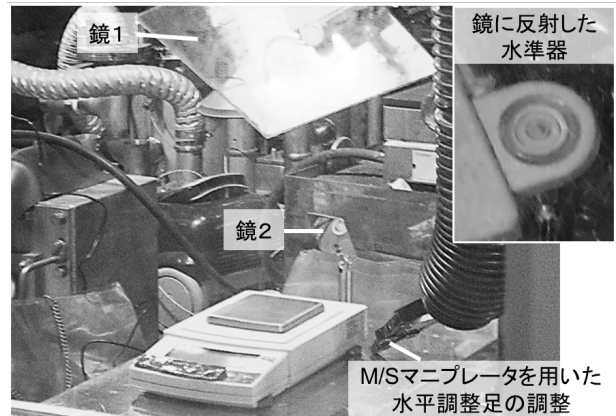
図12 電子天秤の水平状態の確認、調整
