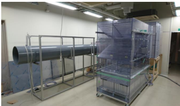
図16 大流量実用化適正試験装置の外観 (内部を可視化するため装置は透明塩基板製)
